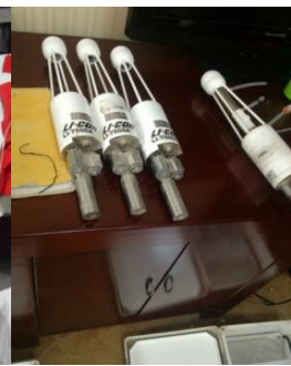
涡动相关仪(CO 2 /H 2 O) 的标定
