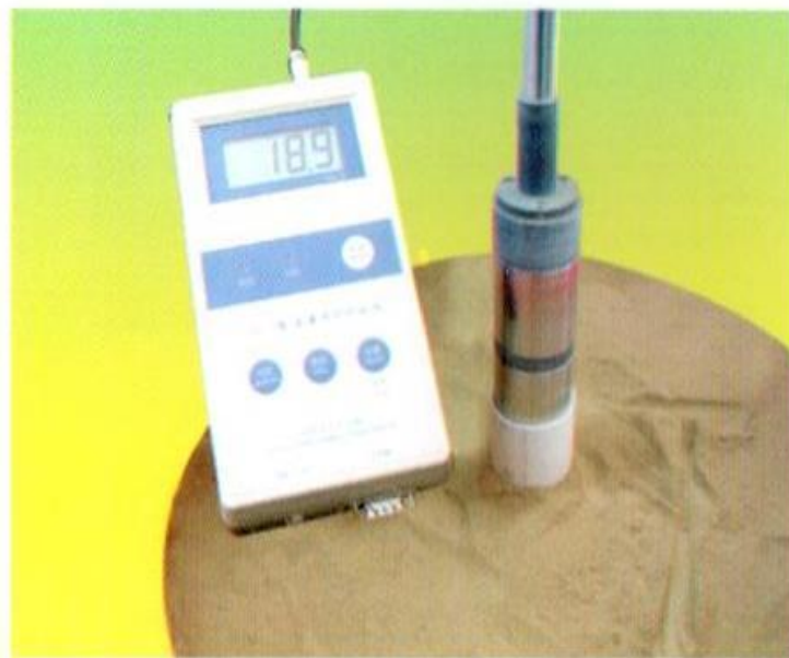
导入管式土壤水分测定仪工厂标定和精度检验的“标准土壤环境土体”
