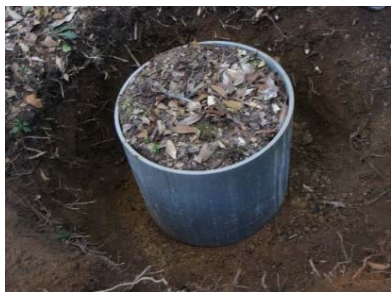
哀牢山土柱原位置换试验
