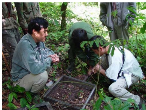
西双版纳热带季雨林土壤呼吸装置安装
