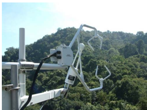
西双版纳热带季雨林通量观测设备
